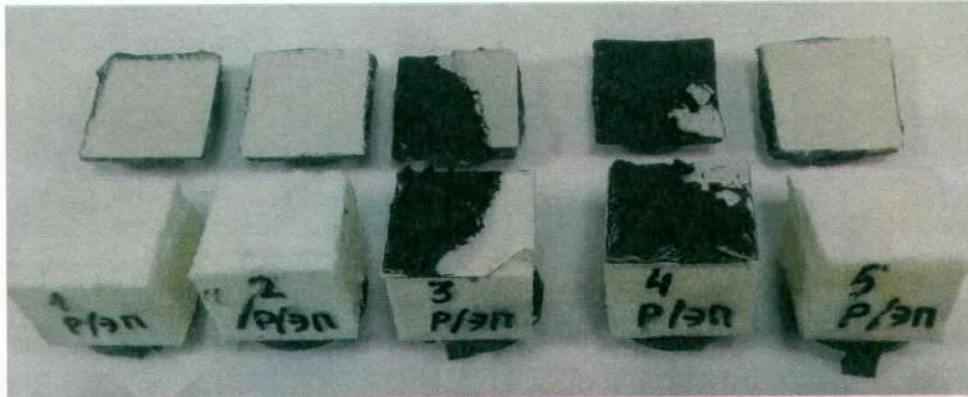
Рисунок 2 – Образцы теплоизоляционных плит LOGICPIR PROF CXM/CXM склеенных с помощью горячего битума с кровельным битумно-полимерным рулонным материалом Биполь ЭПП после их испытания по определению прочности сцепления
