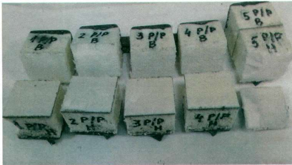
Рисунок 3 – Образцы теплоизоляционных плит LOGICPIR PROF CXM/CXM склеенных между собой с помощью горячего битума после их испытания по определению прочности сцепления
